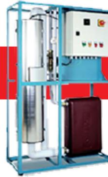
Для предприятий предъявляющих высокие требования к содержанию масла в сжатом воздухе, для технологических процессов где необходима гарантированная очистка сжатого воздуха от масляных паров в течении длительного времени компания DALGAKIRAN может предложить блоки химической фильтрации серии DC-SV. Остаточное содержание масла в сжатом воздухе после угольной колонны составит не более 0,0025 мг/м<sup>3</sup>.
